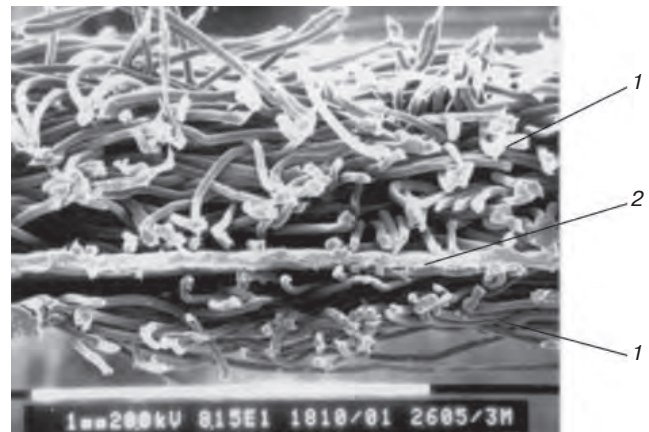
Рис. 3. Микрофотография супердиффузионной трехслойной мембраны [4]: 1 – каркас мембраны; 2 – диффузионная полипропиленовая пленка
