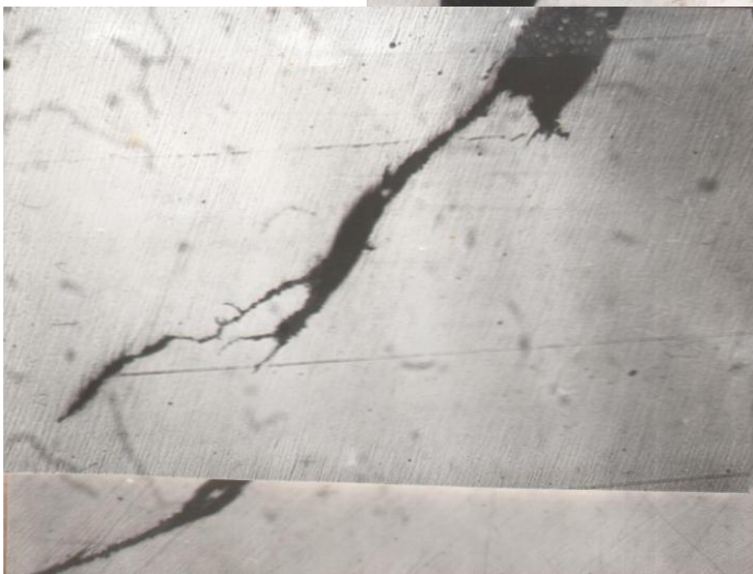
Рис. 6. Внешний вид дефекта на микрошлифе, x70
