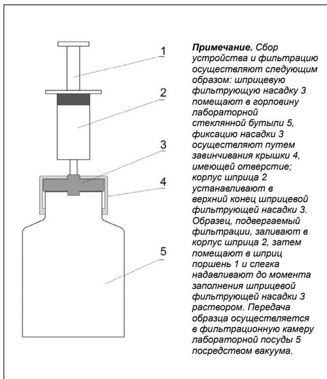
**Рисунок 1.** Устройство для фильтрации растворов, содержащих клетки микроорганизмов.
