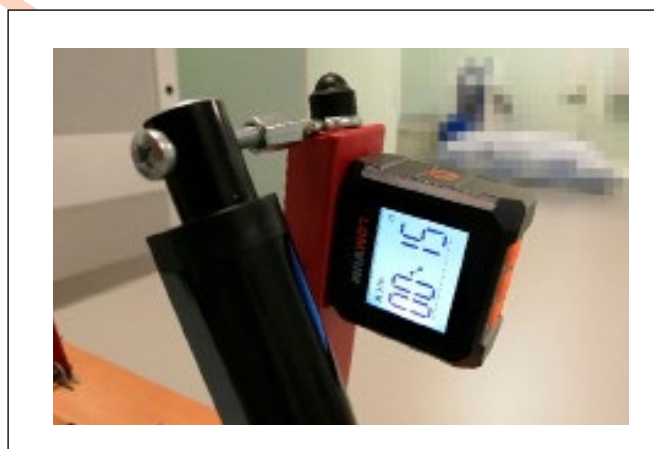
Рисунок 3. Устройство для поворота стоп с угломером: 1 – стоподержатель, 2 – электронный угломер, 3 – линейный актуатор, 4 – основание устройства, 5 – блок управления актуаторами с радиоприемником.
