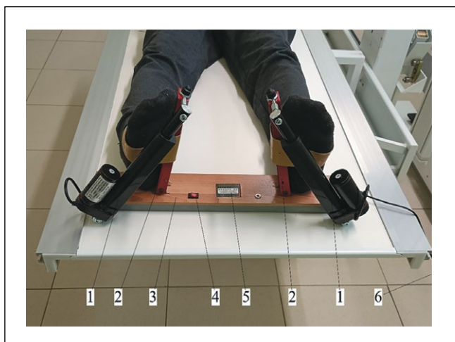
Рисунок 1. Устройство для поворота стоп пациента: 1 – линейный актуатор, 2 – стоподержатель, 3 – основание устройства, 4 – кнопка включения, 5 – блок управления актуаторами с радиоприемником, 6 – электропровод питания.
