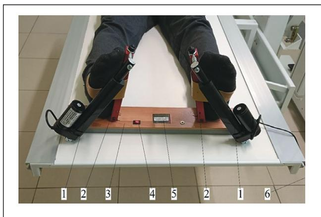
**Рисунок 1.** Устройство для поворота стоп пациента: 1 – линейный актуатор, 2 – стоподержатель, 3 – основание устройства, 4 – кнопка включения, 5 – блок управления актуаторами с радиоприемником, 6 – электропровод питания.
