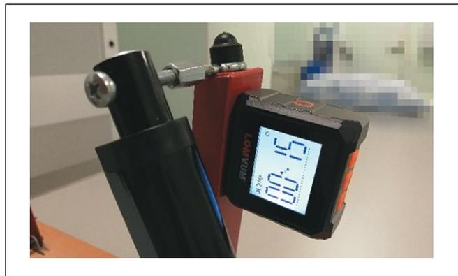
**Рисунок 3.** Устройство для поворота стоп с угломером: 1 – стоподержатель, 2 – электронный угломер, 3 – линейный актуатор, 4 – основание устройства, 5 – блок управления актуаторами с радиоприемником.
