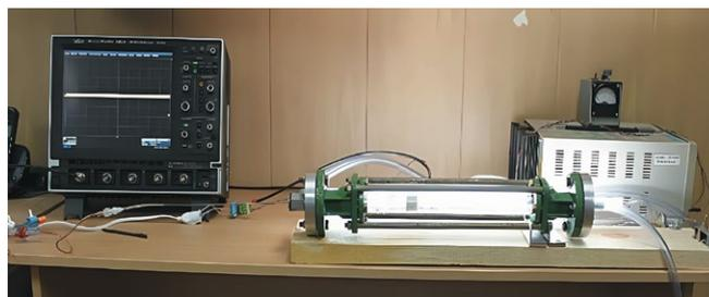
**Рисунок 1.** «Устройство для моделирования внутриартериального кровообращения».
